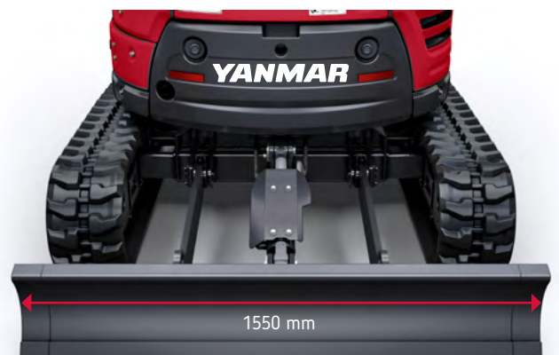
Extension : stabilité accrue pour des performances de fouille et de chargement améliorées
